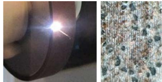
Abbildung 3. Laserabrichten von Diamantschleifscheiben (links); und generierte Nuten in der Oberflächentopographie (rechts).
